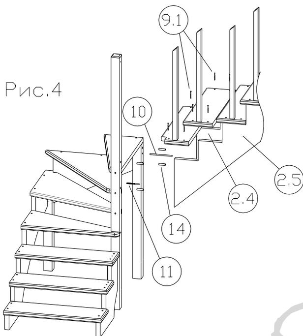
6. В моделях с подступенями устанавливать их следующим образом-один край подступени вставляется в паз верхней ступени, а другой прикручивается к торцу нижней ступени саморезами L=40мм (9.3).
