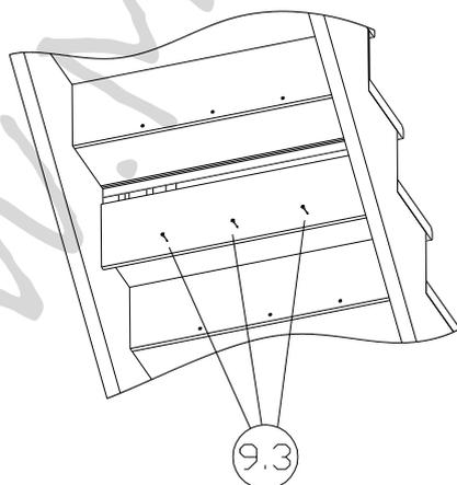
5. В пол второго этажа вкрутить сантехнический болт (11), на него установить столб (3.5) и затянуть гайкой. Прикрутить подпоручень (4.4) к балясинам саморезами L=40мм (9.3). Прикрутить поручень (4.2) к подпоручню (4.4) саморезами L=40мм (9.3) снизу. Притянуть поручень к столбам (3.4), (3.5) саморезами L=100мм (9.2). Поручень на первом марше собирается аналогично. Прибить гвоздями (15) декоративные планки (7) (23 штуки) между ступенями к косоурам.
