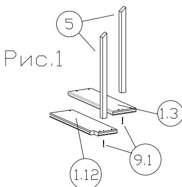
2. Соединить косоуры (2.1), (2.2) со столбом (3.1) и вставкой (3.6) соответственно с помощью шкантов L=60мм (13.1) и сантехнических болтов (10.1), затянуть болты гайками. Установить и закрепить ступень (1.3) с балюсиной (шаг 1) и ступени (1.1), (1.2) на косоурах (2.1), (2.2) саморезами L=70мм (9.1).
